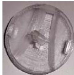
Slika 6: Pramodel gumba izdelan iz epoksidne smole
